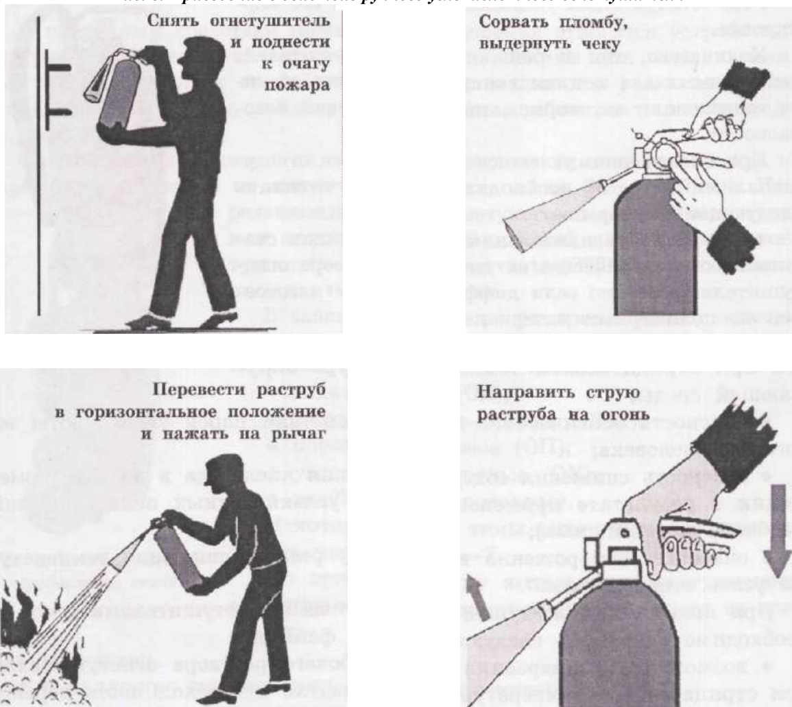
Рис. 8. Приведение в действие ручного углекислотного огнетушителя
